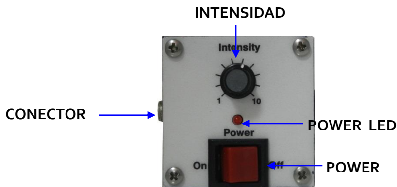
Figura 3. Caja de control
